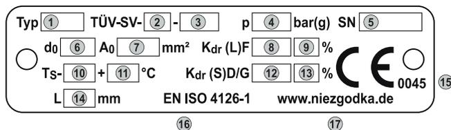
Abbildung 2: Typenschild nach DIN EN ISO 4126
